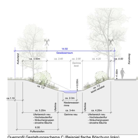
Querprofil Gestaltungsschema C (Beispiel flache Böschung links) (Charakterisierung als Wiesenbach mit variablen Uferbereichen)
