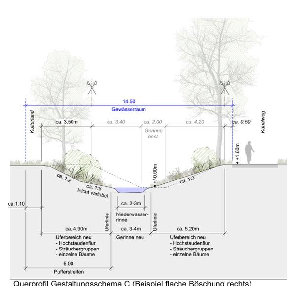
Querprofil Gestaltungsschema C (Beispiel flache Böschung rechts) (Charakterisierung als Wiesenbach mit variablen Uferbereichen)
